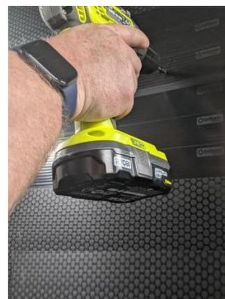
6. Solidariser l'assemblage par des vis de type auto-taraudeuses / auto-perçantes
