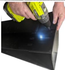
4. Former la réhausse en refermant le triangle et maintenez la réhausse ainsi formée par une vis auto-taraudeuse / auto-perçante en partie supérieure
