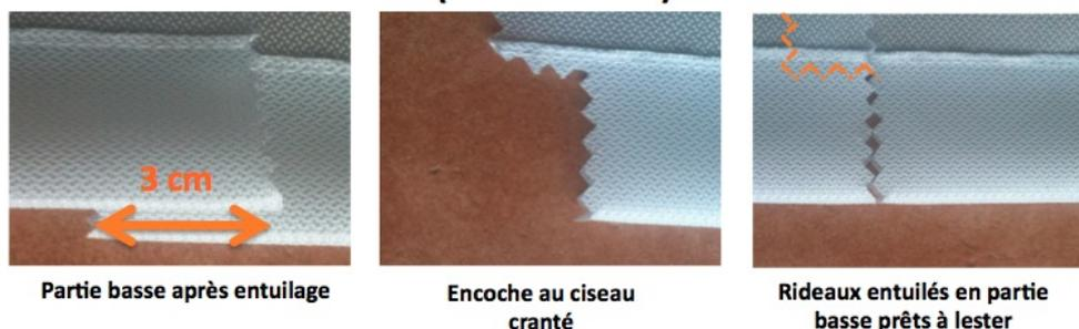
Toute découpe textile devra être réalisée à l'aide de la paire de ciseau crantée fournie avec le 1<sup>er</sup> envoi, ceci afin d'éviter l'effilochage et la volatilité de particules.
