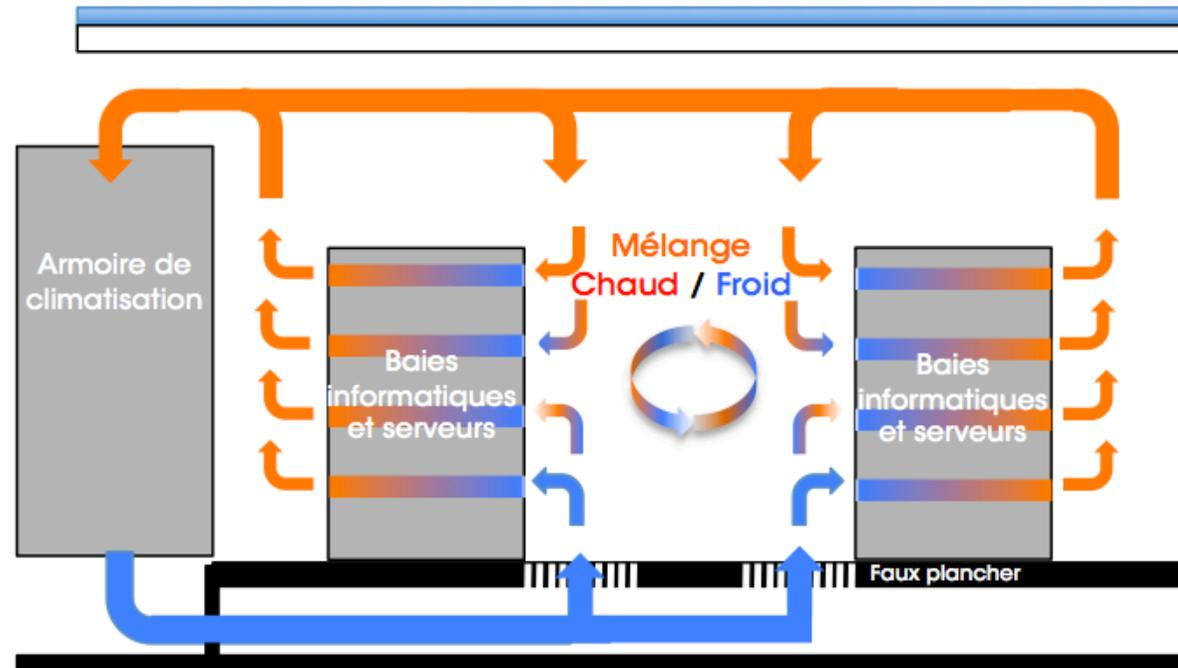
Dans la majorité des cas, le refroidissement des salles informatiques s'effectue par soufflage d'un air climatisé sous un faux plancher. Cet air refroidi sort dans la salle par des dalles perforées disposées à l'aplomb des faces avant des baies informatiques afin de distribuer le refroidissement sur chacun des serveurs qui s'y trouvent insérés horizontalement.
