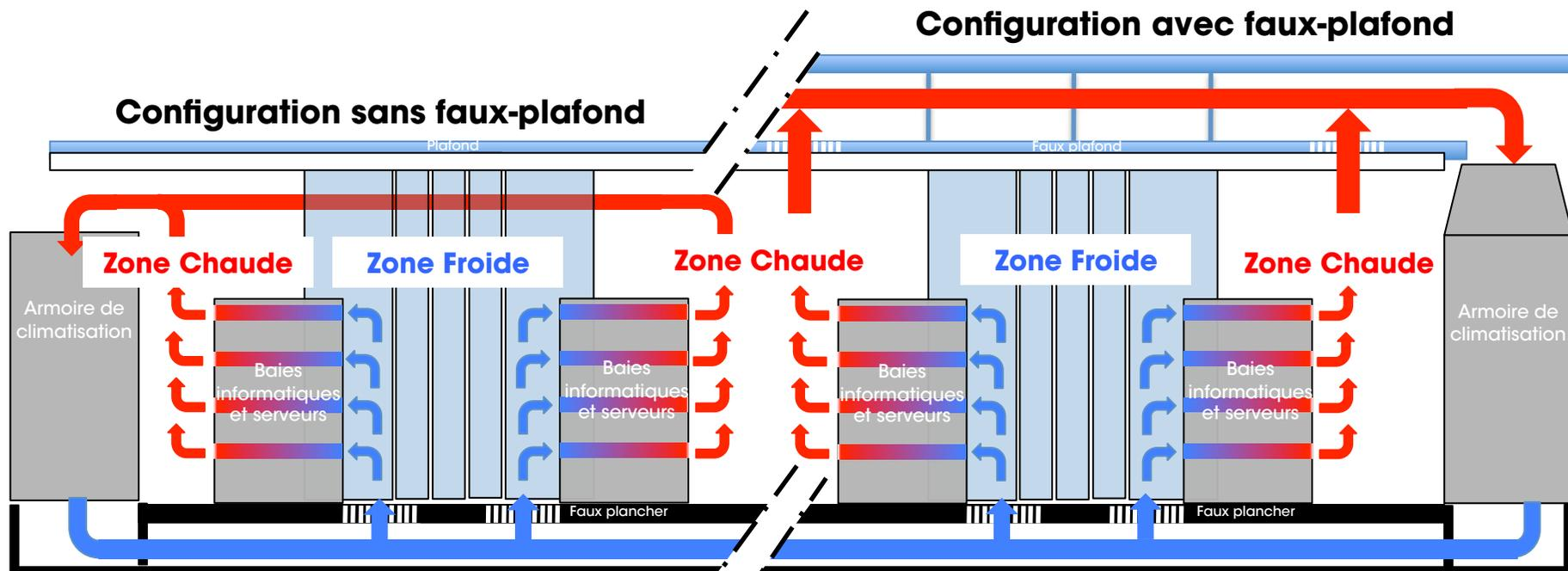
Le cloisonnement permet de créer une « bulle froide » autour des faces avant des baies informatiques. Les fluides Froids et chaud ne se mélangent plus et permettent :
