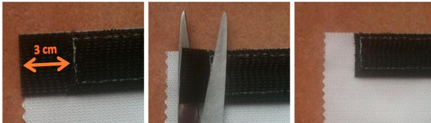
L'entailage des rideaux les uns sur les autres se gère par un recouvrement de 3, 5 ou 10 cm suivant les cas. En partie haute (l'accrochage), la continuité est assurée par une finition de la couture 3, 5 ou 10 cm avant le bord du rideau et l'enlèvement de cette chute afin que la bande autoagrippante du rideau voisin vienne tanger l'autre
