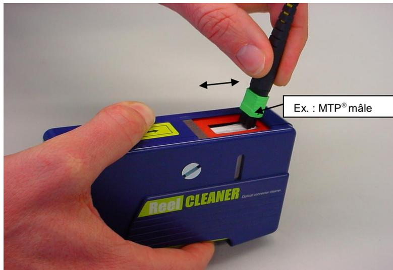
Pour inspecter le résultat/ la qualité du nettoyage, un microscope est nécessaire.
