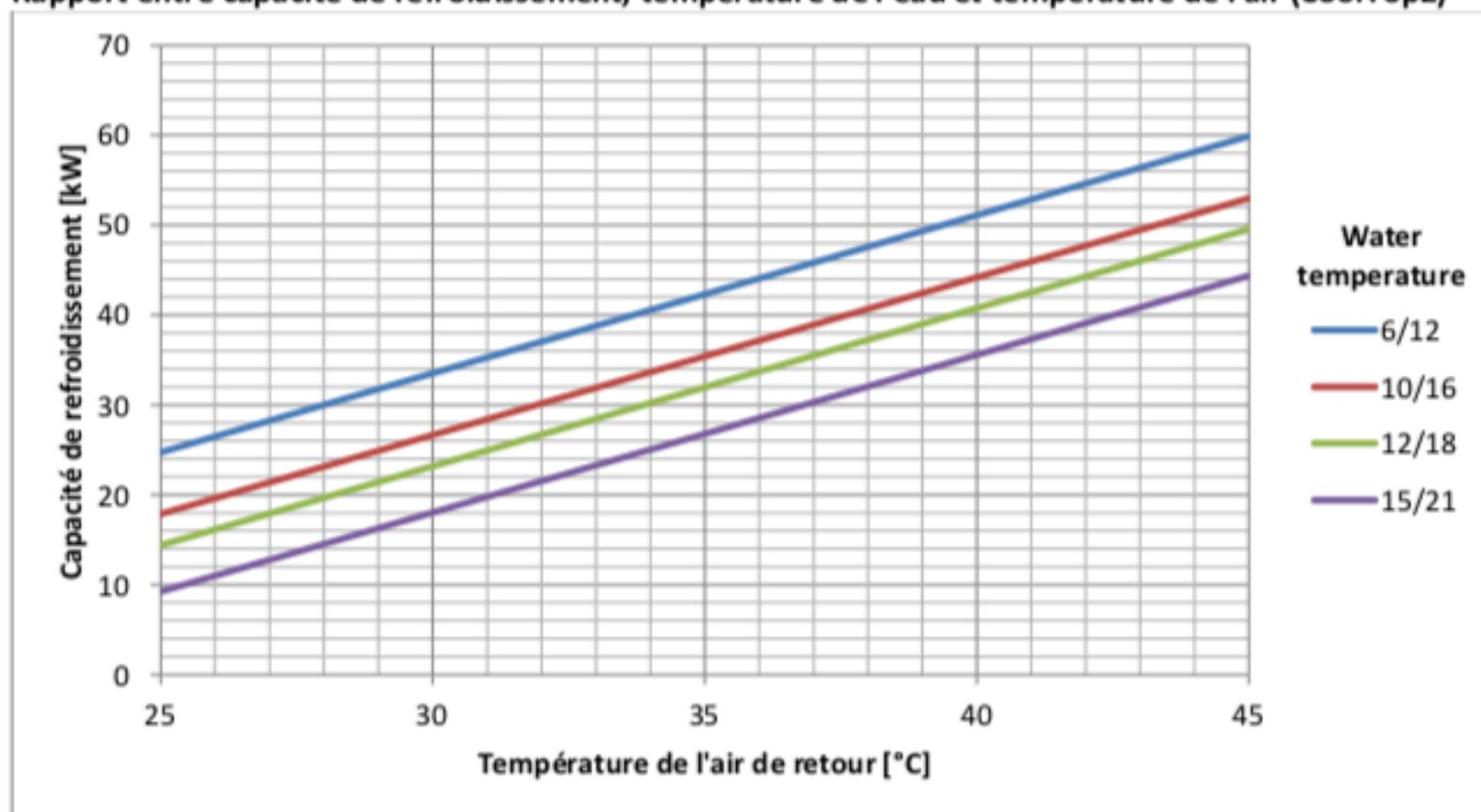
Conditions : ouverture maximale de la valve 3 voies.
