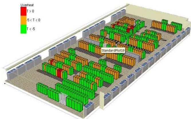
**Cartographie des équipements présentant un risque de surchauffe (en rouge) et ceux dont la température d'entrée d'air est légèrement en dessous de la température limite spécifiée par le constructeur (en orange)**
