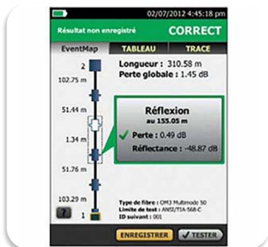
Localisation des points de test au réflectomètre
